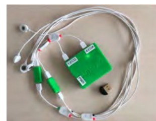
Abbildung 3.3: Bitalino-Kit mit EDA- und ECG-Sensor [12]
