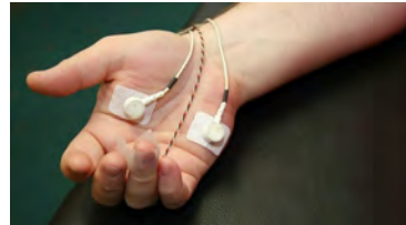
Abbildung 3.1: Beispiel für auf der Haut aufgebrachte Sensoren zur Messung der EDA, Quelle: www.zyto.com
